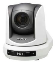
La caméra robotisée BRC-Z330 a été spécialement conçue pour répondre à la demande croissante d'images en qualité Full HD. Elle est dotée d'un capteur CMOS 1/3" 2 Mégapixels offrant une consommation électrique relativement faible. La caméra offre une grande plage Pan/Tilt et une fonction Pan/Tilt/Zoom fluide et discrète, la rendant idéale pour un déploiement dans les salles de conférence, de formation et de concert.
