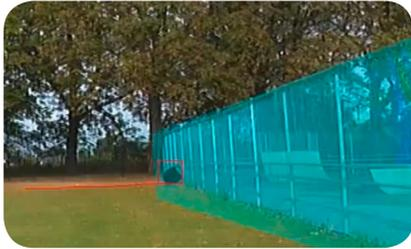
Pour la sécurité périmétrique et la prévention de la criminalité, les caméras peuvent être utilisées comme capteur de détection d'intrusion. Une alarme est générée lorsqu'un objet prédéterminé (personne ou véhicule) traverse la zone de détection. De même, une alarme est générée lorsqu'un objet passe de l'intérieur vers l'extérieur d'une zone de détection.
