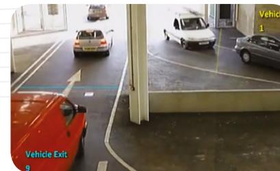
Le tailgating d'objet est défini comme deux objets traversant une ligne ou une zone virtuelle à l'intérieur d'un cadre temporel prédéfini. Cela convient aux véhicules ou aux personnes dans un environnement de contrôle d'accès.
