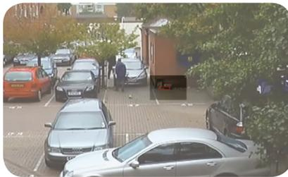
Les objets qui sont arrêtés à l'intérieur d'une zone ou qui restent à l'intérieur d'une zone plus longtemps que la durée définie déclenchent une alarme. Idéal pour identifier une personne qui flâne.
