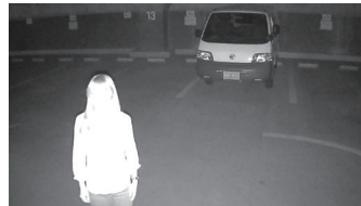
Technologie IR traditionnelle (impossibilité d'identifier les objets proches en raison de surexposition)
