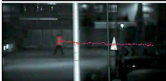
VISION NOCTURNE D'UN PARKING : ZONE INTERDITE / INTRUSION.
